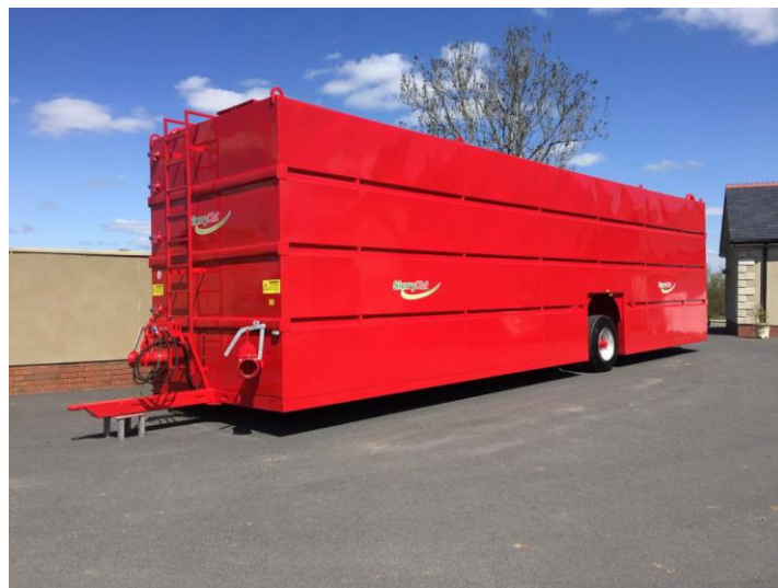
Figur 5: 100 m 3 gjødselvogn fra SlurryCat
