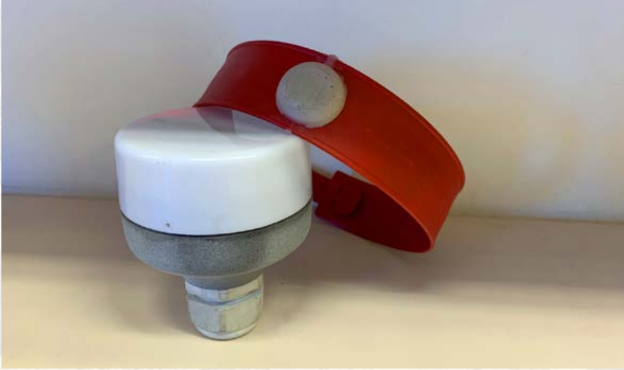
Bilde 2. 2019-generasjonen av «blinklys-mottaker» (t.v.) og «senderklave» (t.h.). Foto: Johannes Karlsson
