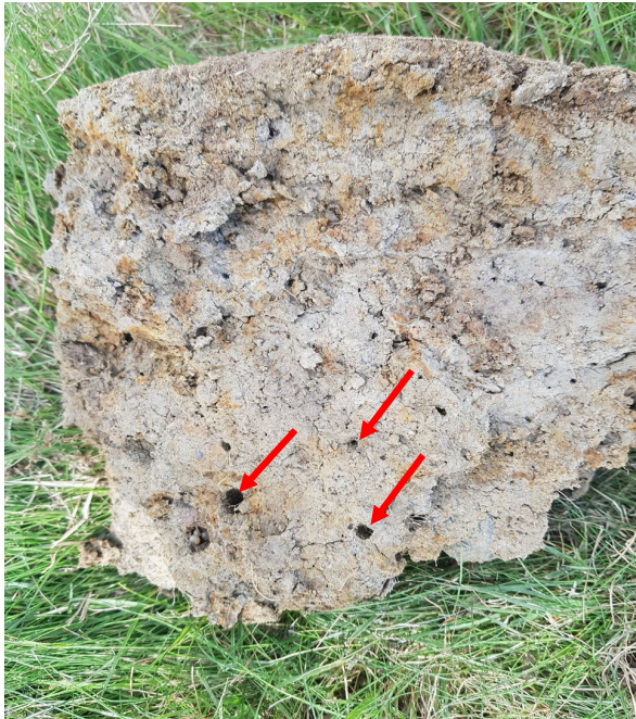
Figur 1: Makroporer, markert med røde piler, bidrar til rask transport av vann nedover i jorda.
