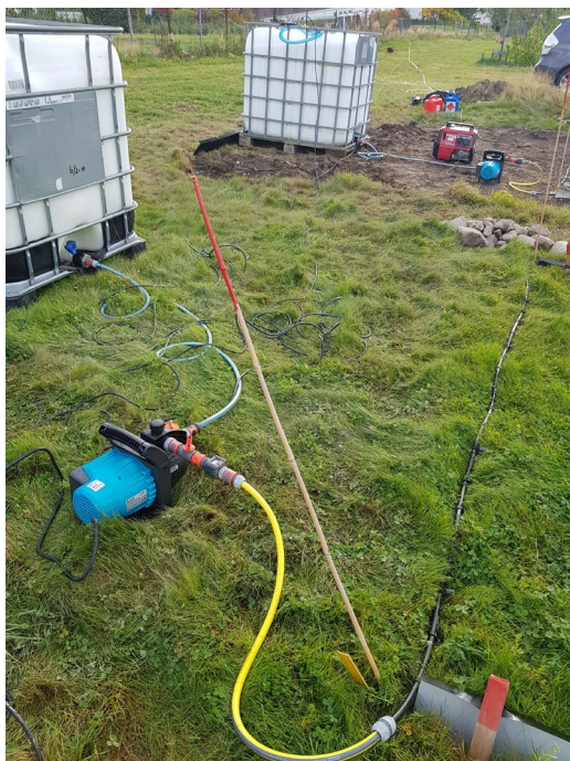
Figur 6: Vanntankene ble koplet til en pumpe og videre til dyseslanger som fordelte vannet inn i vegetasjonssonene ihtt en rate på ca 3 liter/minutt. Slangene som ble benyttet var standard Gardena hageslanger (½", d=13 mm) med koplinger og overganger.
