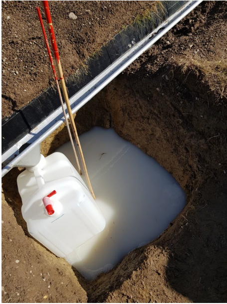
Figur 8: Det meste av vannet lekket ut via åpne makroporer i jordprofilen, langs leirlaget ved 30 cm eller via drenerørrene. Grøftene ble fylt opp av plantevernmiddeleløsning og måtte lense fortløpende. Prøver måtte tas direkte fra grøftene.
