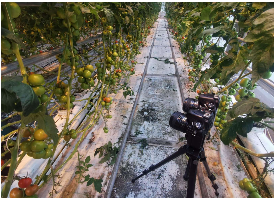
Figur 8: Bilde av avbildning med stereo-rigg bestående av to Nikon D800e speilreflekskameraer
