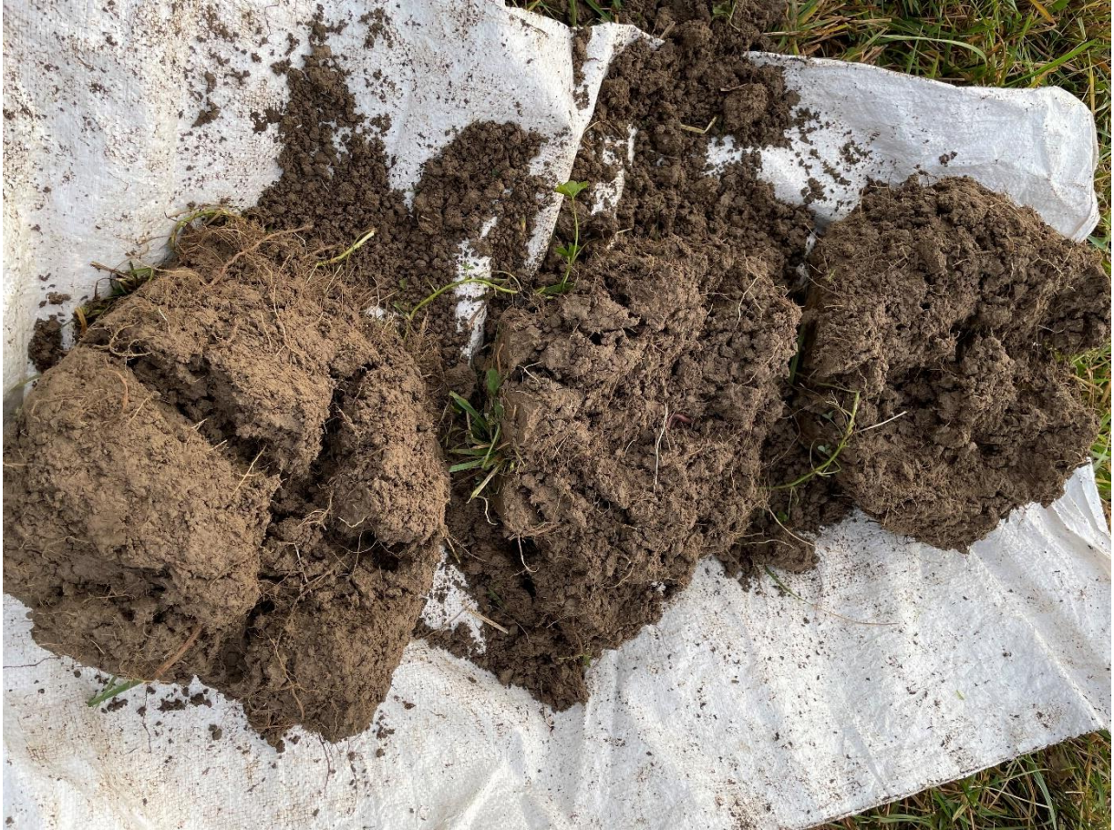
Bilde 9 Spadetak fra toppjord forsøks felt i Østfold høst 2021, tv tung traktor, midt ingen pakking, th lett traktor. Foto: Julie Wiik
