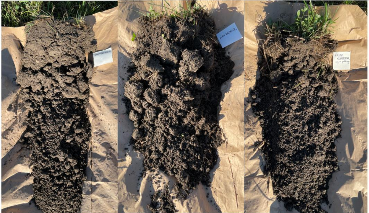
Bilde 8 Jordprofiler fra forsøksfelt i Vestfold 2021, tv tung traktor, midt lett traktor, th ingen pakking. Siltig lettleire. Foto: Julie Wiik
