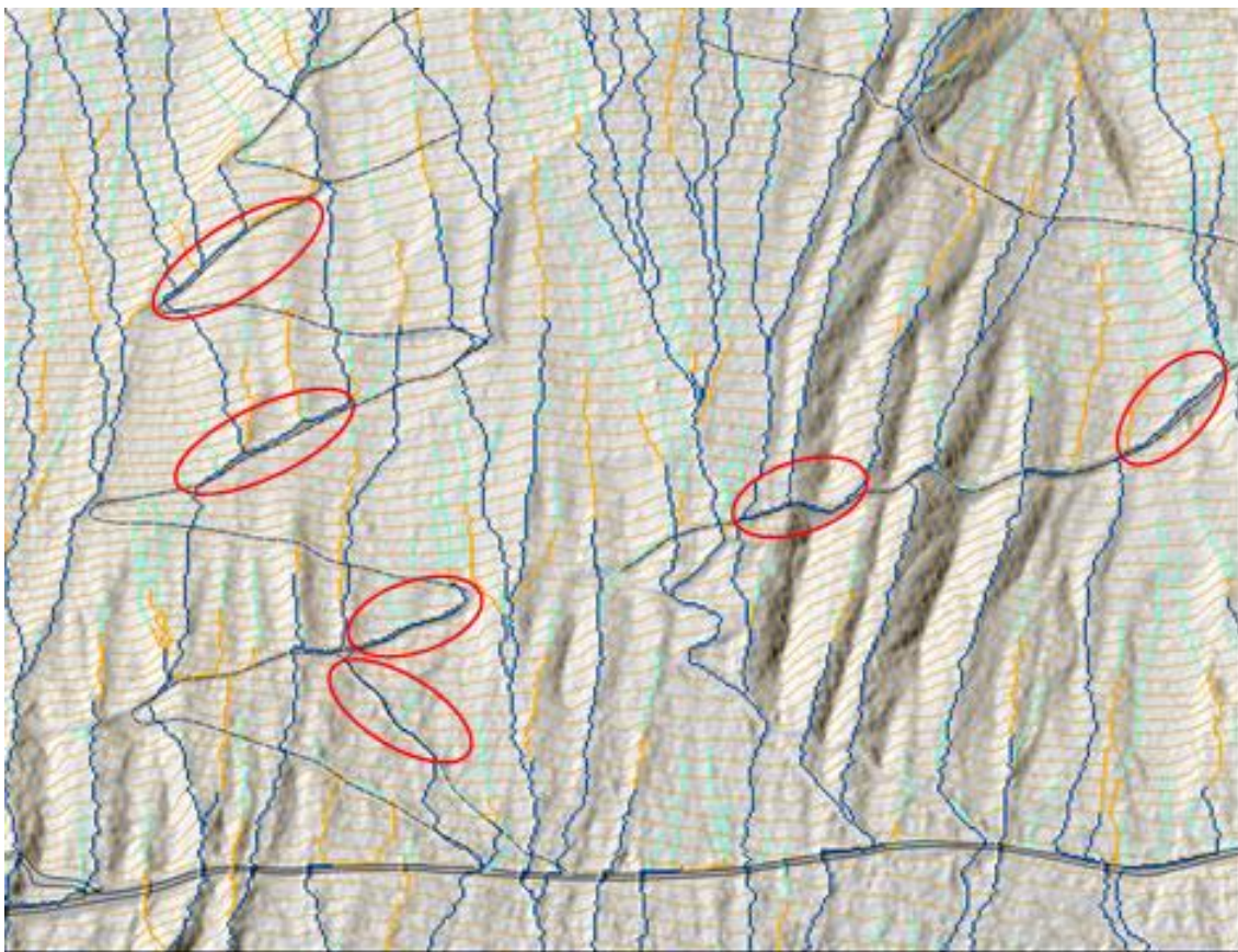
Figur 10. Flomavrenningskart. Rød utheving viser beregnet vanntransport langs traktorvei.
