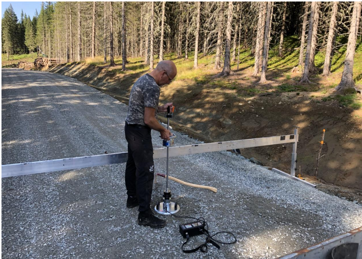
Bilde 3: Bæreevnmåling utført av veiplanlegger Bjørn Arve Øvereng på en nybygd vei. En solid og fint utformet vei. Bilde: Martin Bråthen.
