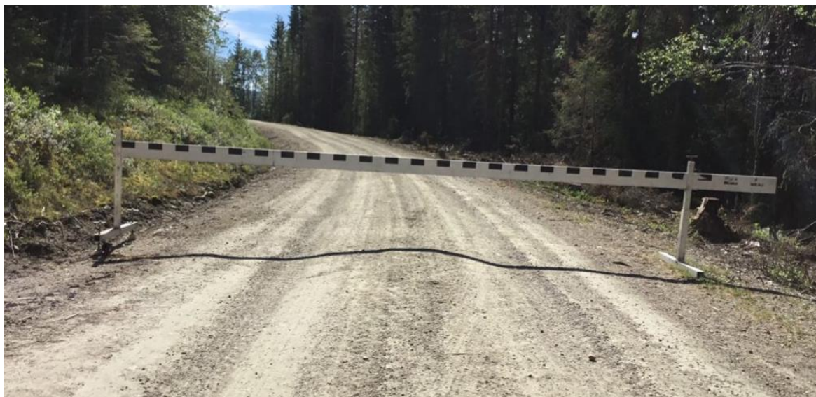
Bilde 6: Laserprofil og målefoto ble brukt for å identifisere hjulspor og veimidt
